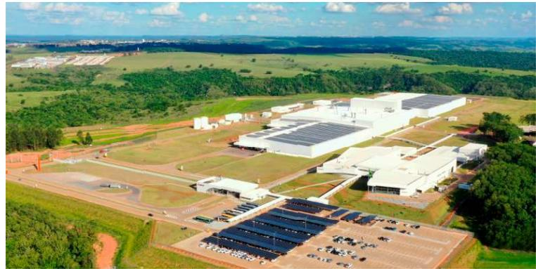
São 9.748 módulos de placas instalados no telhado 1.602 no estacionamento
